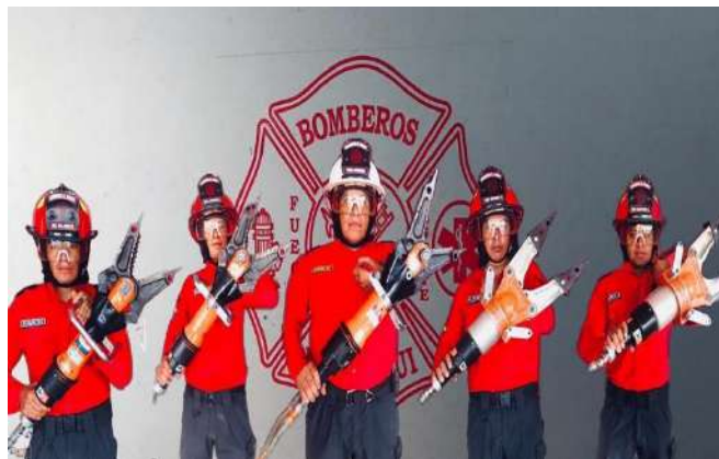
Equipo de Extricación Vehicular, herramienta muy necesaria que facilitará el rescate de las personas atrapadas entre fierros retorcidos en los accidentes de tránsito.
